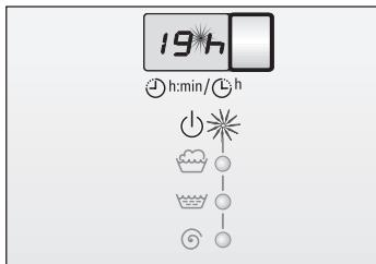
Отсчет времени задержки начинается сразу же после его установки. Это можно определить по мигающей точке между цифрой и «h». Точка мигает до тех пор, пока не истечет установленное время задержки запуска программы «h».
